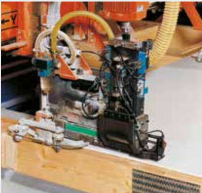
Afbeelding 3.10: Machinale bevestiging met industriële nietmachine
