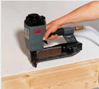
Afbeelding 3.9: Manuele bevestiging met pneumatische tacker
