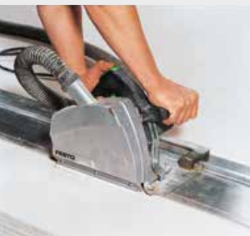
Afbeelding 3.2: Handcirkelzaag met geleidingsrail
