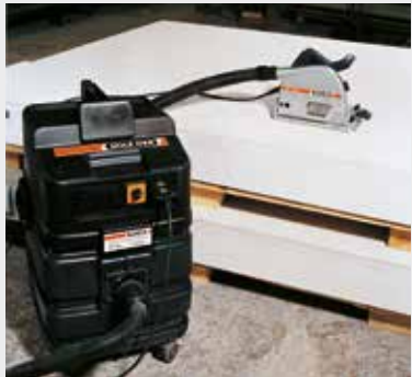
Afbeelding 3.3: Handcirkelzaag met stofafzuiging
