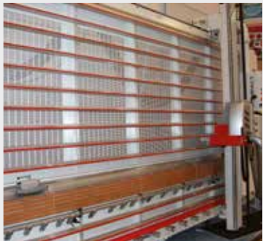
Afbeelding 3.1: Platen op maat zagen met een platenzaag
