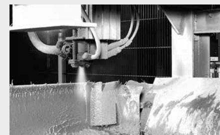
Afbeelding 1.2 : Aanbrengen van de plaatlaag aan de malzijde
